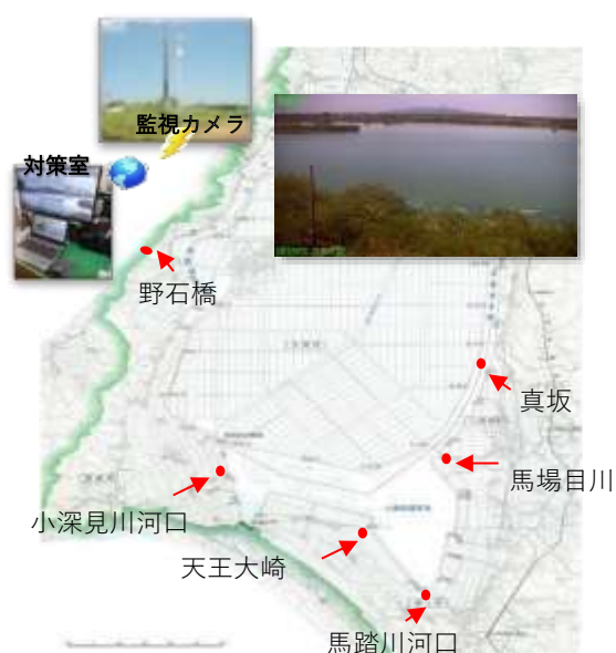
図 34 アオコ常時監視システム
