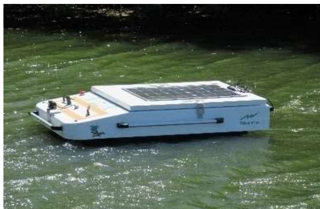
図 36 アオコ抑制装置側面図（寸法：全長 5,200mm × 全幅 3,690mm）
